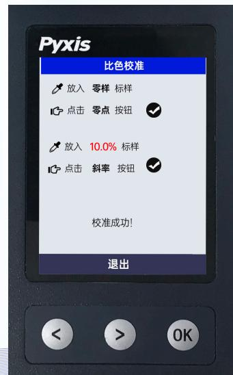
加入10%次氯酸钠标准溶液，点击“斜率”进行校准，出现“√”即为校准成功。点击任意键退至主页面。
