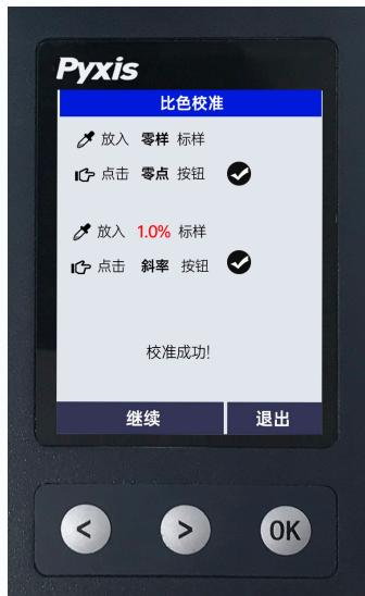
加入1%次氯酸钠标准溶液，点击“斜率”进行校准，出现“√”即为校准成功。
