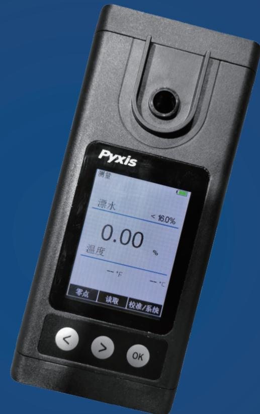
若不使用仪器，请将样品室冲洗干净，避免样品室内部结晶，影响仪器正常使用
