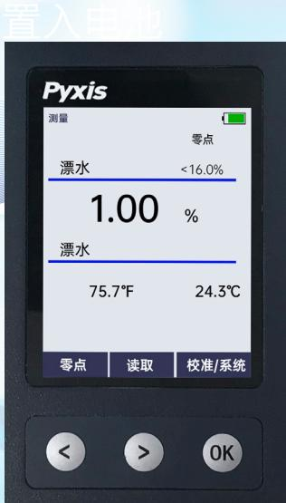
用待测次氯酸钠溶液润洗样品室2-3次，然后注满样品室，选择“读取”进行测量。界面数值稳定后，显示值即为待测次氯酸钠溶液浓度。
