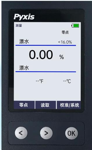
开启SP-210，使用前先用去离子水润洗2-3遍，加入去离子水，选择“零点”进行背景校准。
