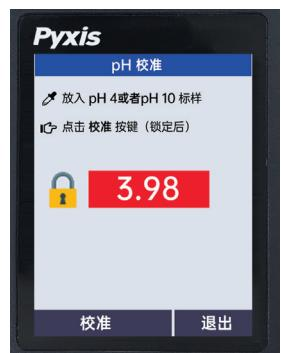
校准前，先使用pH7校准溶液润洗测量槽2-3次，再将pH7校准溶液倒入测量槽中，数值锁定后，选择“pH7”键进行校准
