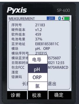
校准前，先使用pH4校准溶液润洗测量槽2-3次，再将pH4校准溶液倒入测量槽中，数值锁定后，选择“校准”键进行校准。
