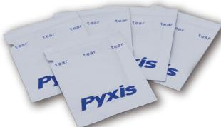
将DPD余氯试剂倒入样水瓶中，若样水中存在余氯，则变成粉红色。最后将反应好的样水放置入测量槽中
