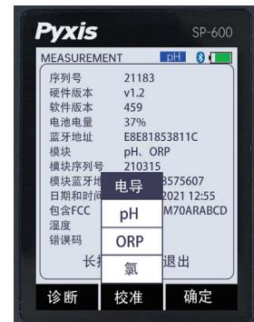
校准前，先使用电导率标准溶液润洗测量槽3次，再将电导率标准溶液倒入测量槽中，选择“校准”和“OK”键
